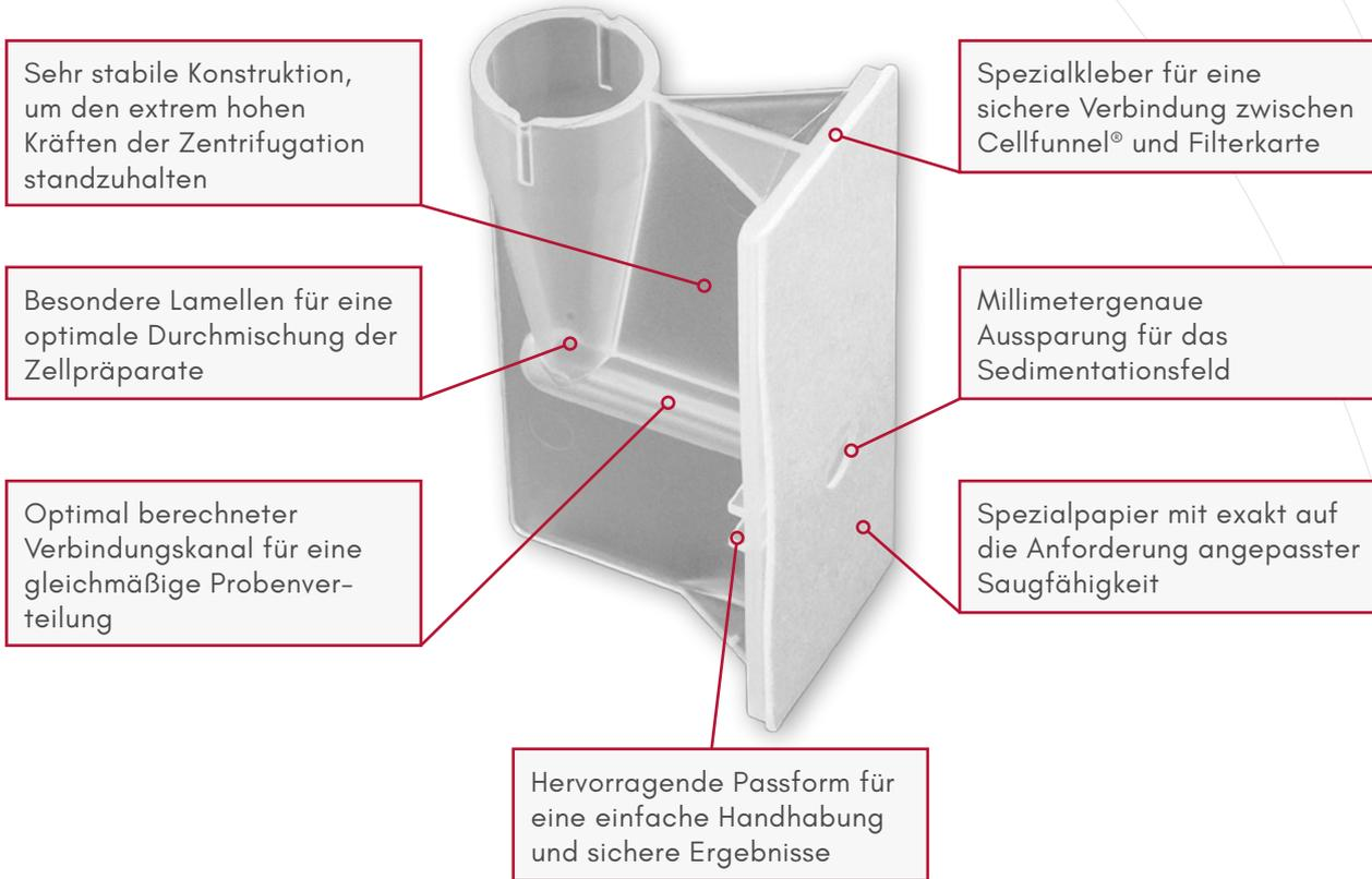
Die Abbildung oben zeigt das Einweg-Single Cellfunnel® (Art.-Nr. 320-100 bzw. 320-500). THARMAC® bietet auch Double Cellfunnel® und ECOfunnel® an. Alle Systeme sind als Ein- und Mehrweg verfügbar und auch passend für Shandon™ Cytospin™ - Probenvolumen von 0,1 - 5 ml.
